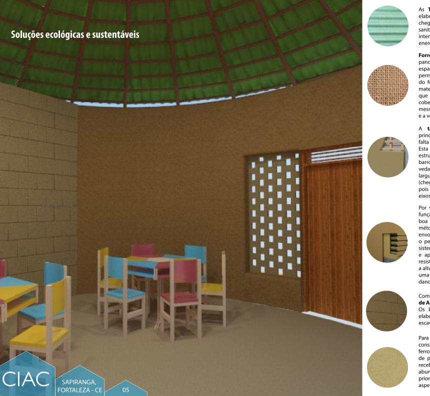
As **Telhas Ecológicas** da Fortuna são resistentes e elaboradas a partir de resíduos que iriam para o lixo, chegando ao seu destino final lotando os aterros sanitários das cidades. Esta telha tem alta resistencia a intempéries além de um ótimo desenvolvimento energético e acústico.
